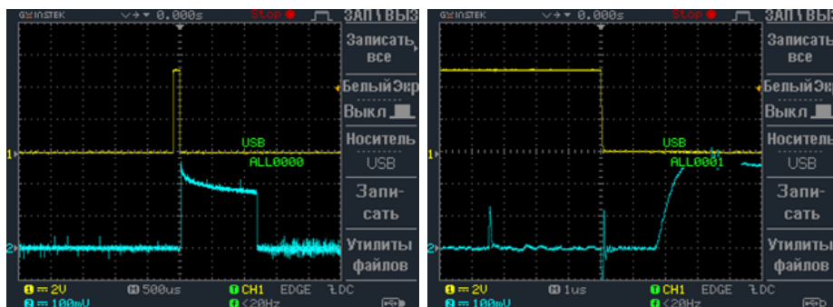
Рисунок 22 — Осциллограммы сигналов преобразователя ёмкость-напряжение без приложенной нагрузки: верхняя эюра соответствует импульсу на фходе преобразователя, нижняя — на выходе. Осциллограмма слева иллюстрирует задержку между поданным на вход импульсом и размыканием ключа
