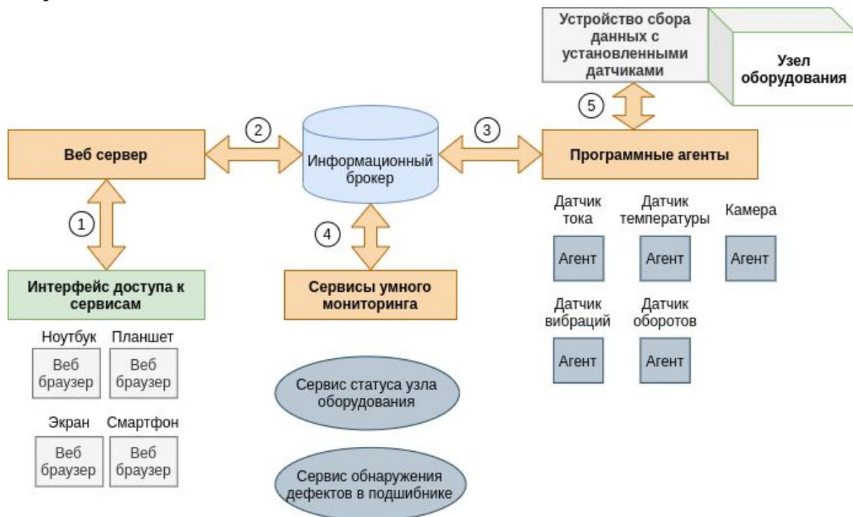
Рисунок 1 — Высокоуровневая архитектура модульной системы мониторинга
