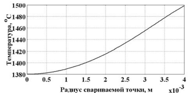
Рис. 3. Распределение температуры на поверхности свариваемой точки при токе в индукторе 1000 А и времени протекания 23 с
