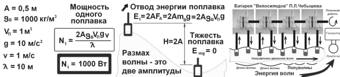
Рис. 2. Схема и расчёт характеристик батареи волновых генераторов
