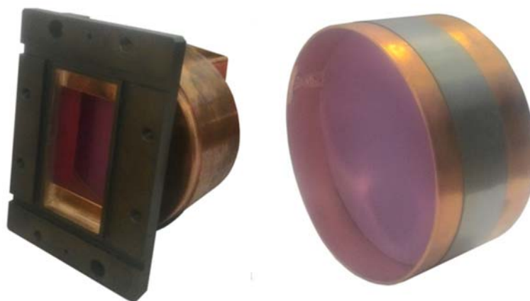
Рис. 2. Баночное окно ускорителя электронов в сборе, работающее на волне E_{11} , и керамический диск, спаянный с медным стаканом
