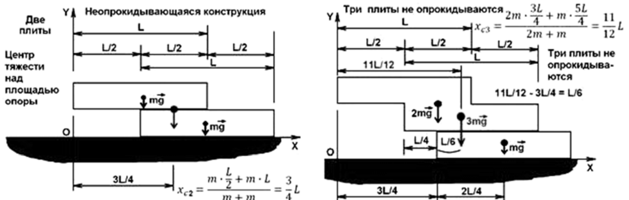
Рис. 1. Простейший случай неопрокидывающейся системы из прямоугольных плит
