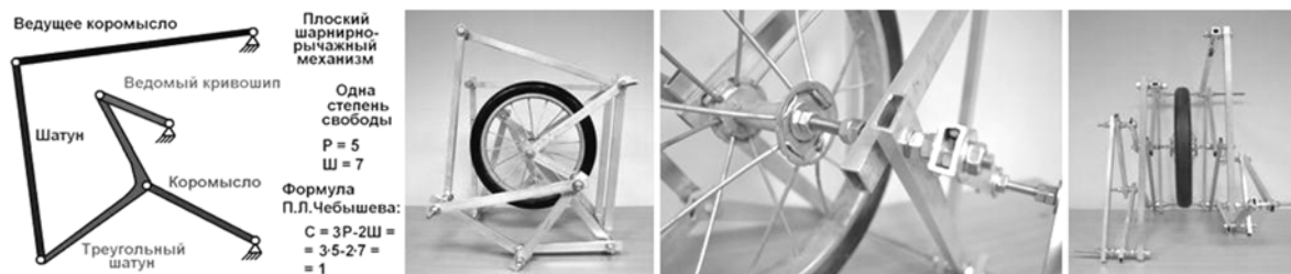
Рис. 1. Кинематическая схема и общий вид собранного механизма
