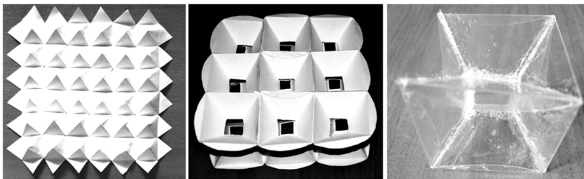
Рис. 2. Уточнение формы ячейки из плёнок по мыльным плёнкам
