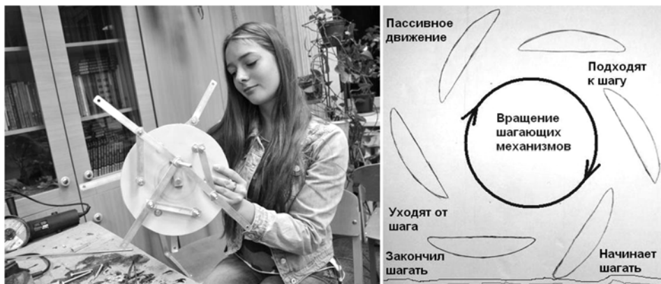
Рис. 1. Общий вид и принцип действия колеса с шагающими механизмами
